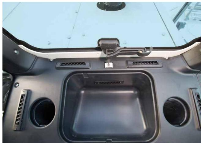
**Щелевые и поворотные дефлекторы** обеспечивают эффективный обдув оконных проемов и предотвращают их замерзание и запотевание.
