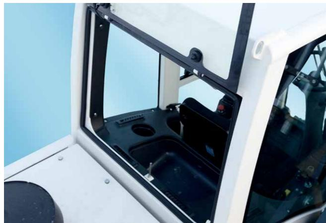
**Открывающееся заднее окно** обеспечивает удобное проветривание, может служить аварийным выходом при чрезвычайных ситуациях, полезно при проведении ТО и ремонта.
