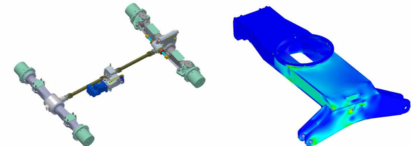
**Мосты** оборудованы необслуживаемыми дисковыми тормозами с гидроприводом. Блокировка дифференциала обеспечивает повышенную проходимость на бездорожье.
