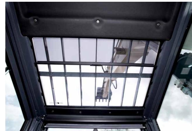
**Оконный проем в крыше кабины** с защитной решеткой обеспечивает визуальный контроль рабочего оборудования.
