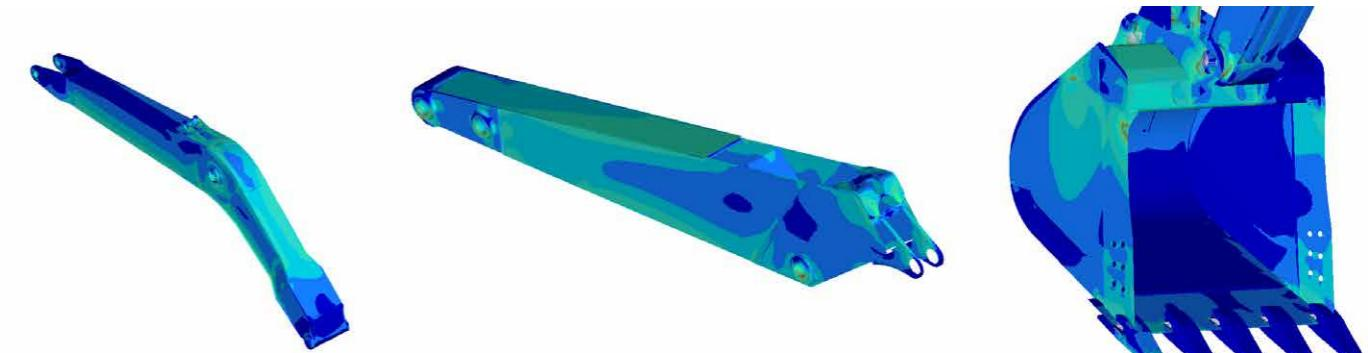
Усиленное **рабочее оборудование** предназначено для тяжелых высокопроизводительных работ. Прочность обеспечивается за счет применения легированных сталей. Все элементы конструкции созданы при помощи 3D - проектирования и проверены на прочность посредством FEM-анализа.
