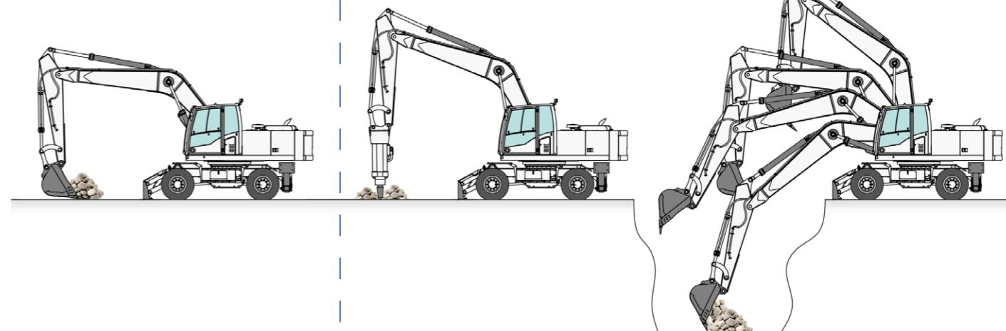
Функция помогает при планировочных работах для получения ровной площадки. Работа ведется только рукоятью и ковшом, стрела при этом под собственным весом свободно перемещается вверх и вниз.
