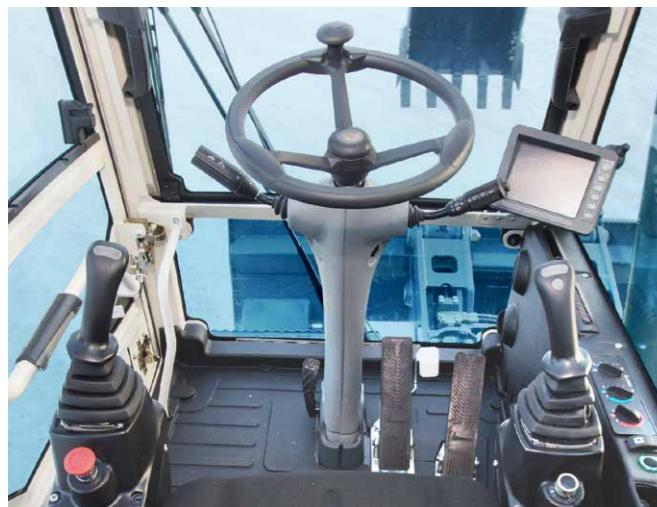
**Рулевая колонка** имеет узкий профиль и не загораживает обзор. Колонка имеет регулировки по вылету и углу наклона. Органы управления коробкой передач удобно сгруппированы на рулевой колонке.
