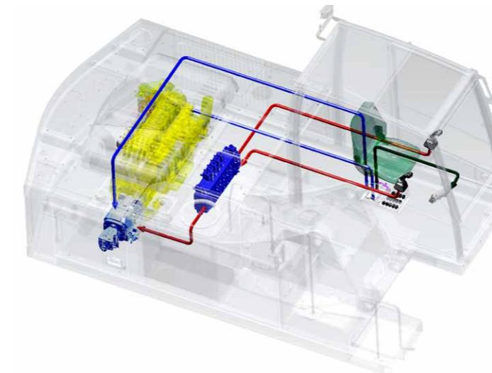
Гидравлическая система обеспечивает распределение потока между исполнительными механизмами, независимо от приходящихся на них нагрузок.
