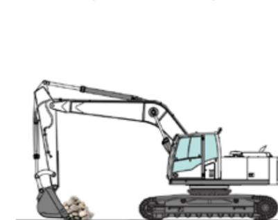
Функция помогает при планировочных работах для получения ровной площадки. Работа ведется только рукоятью и ковшом, стрела при этом под собственным весом свободно перемещается вверх и вниз.
