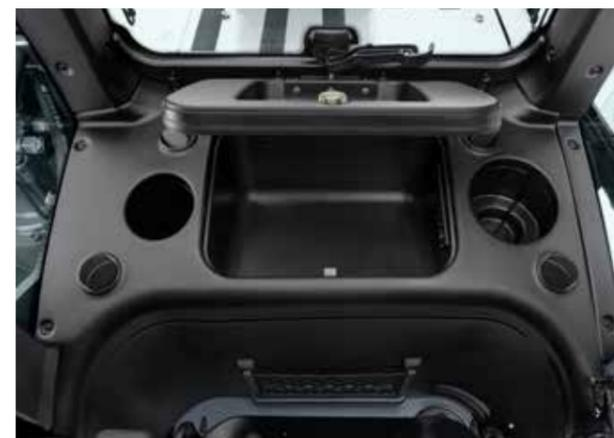
**Удобная система хранения** представлена отсеком охлаждения и нагрева продуктов, а также двумя термосодержателями.
