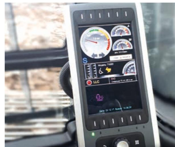
**ЖК-дисплей** диагональю 7 дюймов отображает все ключевые показатели работы экскаватора. На дисплей также выводится изображение с камеры заднего вида.
